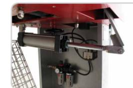
Pneumatik-Option „Öffnen/Schließen“ des Schweißrahmens per Luftdruck
